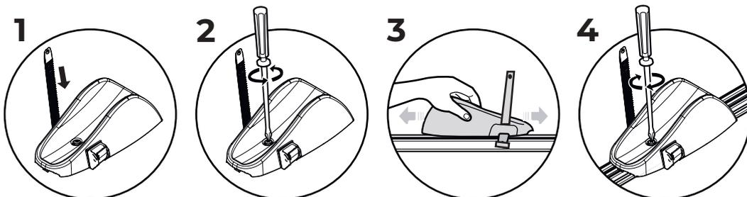
Установите прижимной ремень в положение, показанное на схеме 1. Ослабьте винт крепления, вставьте его в продольный паз на велокреплении. Отрегулируйте положение ремня под колесо велосипеда и затяните соединение.
