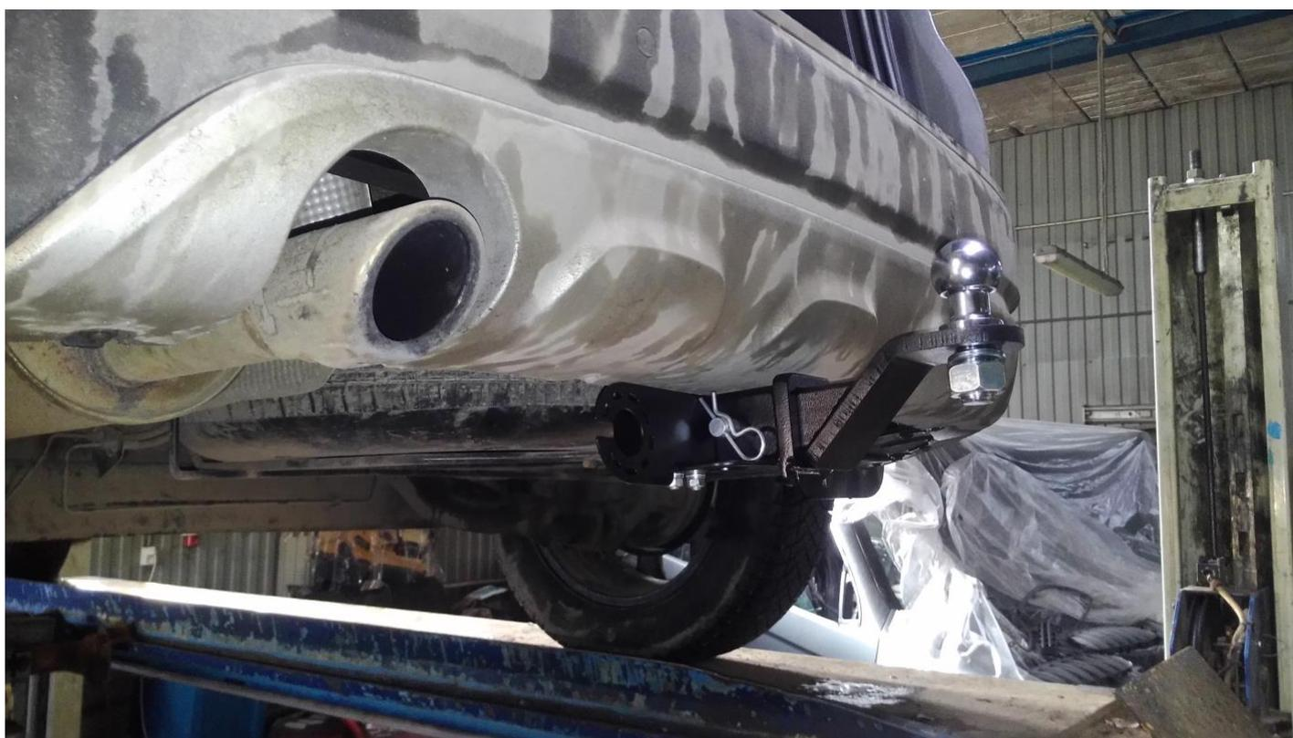
**При транспортировке велолатформы, рекомендуется использовать усиленный вариант кронштейна-вставки.**
